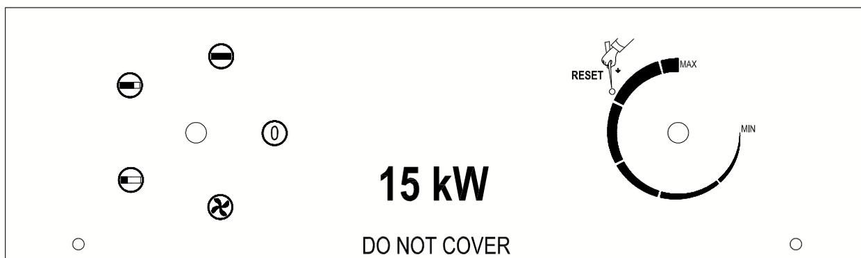
Interrupteur rotatif à trois, quatre et cinq positions, pouvant être tourné de 0 à 360 degrés dans le sens horaire et antihoraire. Le premier niveau correspond au ventilateur seul, le second niveau à 5 KW, le troisième niveau à 10 KW et le quatrième niveau à la pleine puissance. Vous pouvez régler le niveau dans les sens horaire ou antihoraire.
